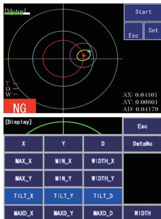
精密モータの面ブレ測定モードです。回転時の動的傾きによる軌跡より、面ブレ・軸倒れ・最外点をデジタル演算します。従来のCCD式オートコリメータによる累積法に比べて正確且つ短時間で表示します。
