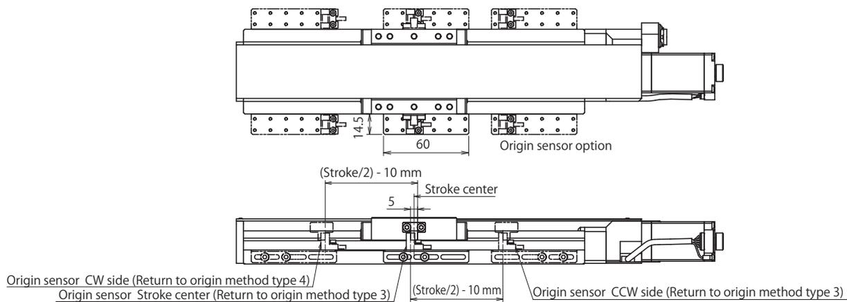
センサオプション外形寸法図(原点センサオプション7)
