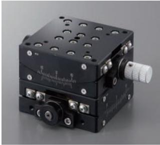
■移動ガイドにクロスローラ・送り機構にウォームギヤを採用した高精度ゴニオステージです。
