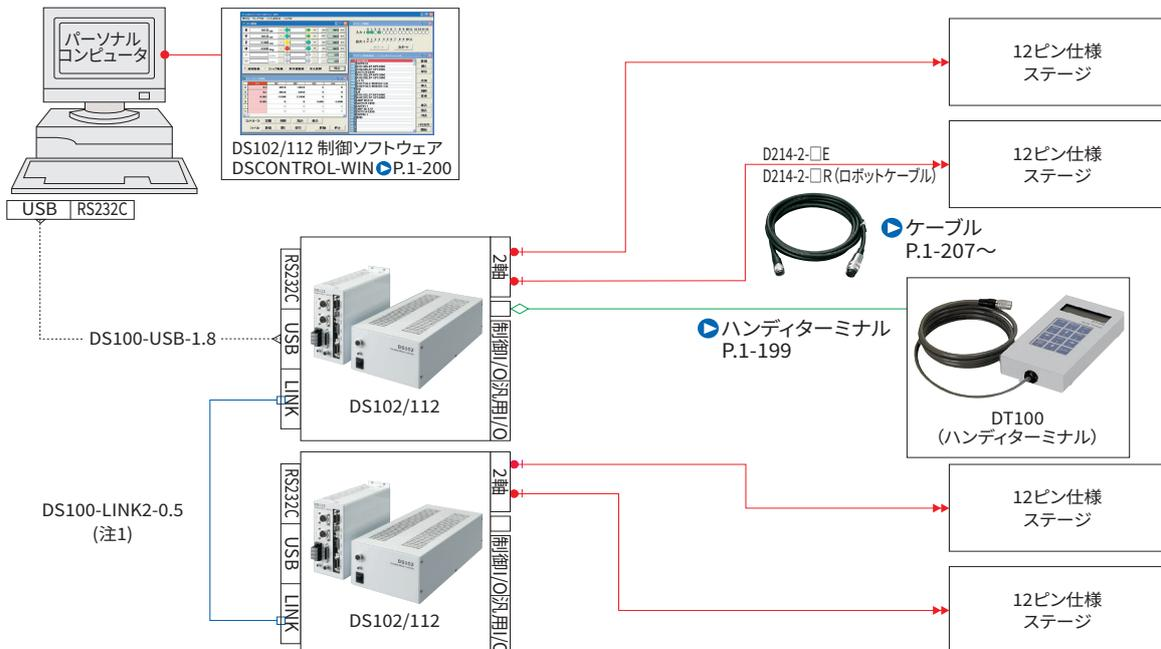
(注1) リンク機能により、最大3台のコントローラと連結(最大6軸制御)して使用することが可能です。
